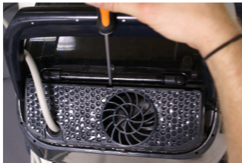
7.1. Pomocou plochého skrutkovača odstráňte ochrannú mriežku.
