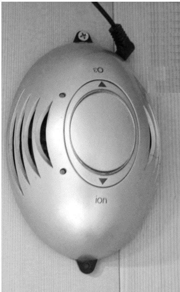
**Tlačidlo ION** slúži na zapnutie ionizátora. Po stlačení sa rozsvieti kontrolná dióda – zelená. Pred a počas používania sauny vyberte variant „Ion“, ktorý má 60 minútový cyklus tvorby záporných iónov.
